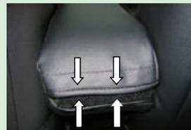
ゆっくりなじませながらかぶせていき、カバー後部のマジックテープで固定します。きつい構造ですので、十分に引き寄せて下さい。
