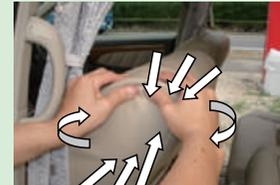
カバーのコーナーがフィットしているか確認して下さい。ずれやダブつきがあるようでしたら、少しずつ引っ張りながら位置を整えて下さい。
