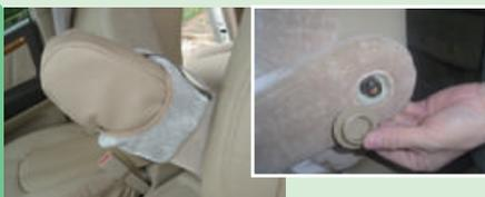
カバーの方向を確認し、カバーの入り口を折り返して慎重に入れ込んでいきます。車種によりアームレスト自体を外すタイプ、外した方が装着しやすいタイプがあります。図のようにキャップを外すと、ボルトで止ま
